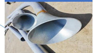
J tube / Cable Conduit
